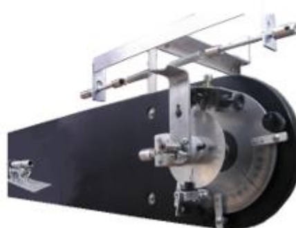
Figura 9- Es un sistema mecatrónico que se fija por la parte exterior de la sección de pruebas del túnel de viento. Sujeta al modelo y le permite oscilar. Integra un sensor óptico que a su vez se conecta a un hardware-software que despliega las lecturas de frecuencia de oscilación de cabeceo en una Laptop.
