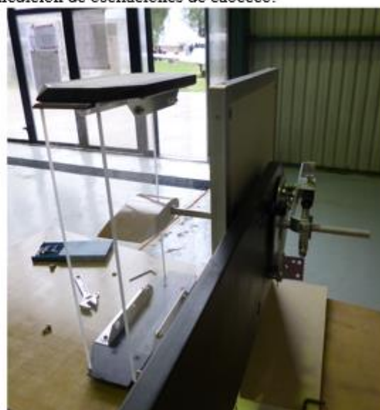
Figura 11- Montaje del experimento fuera del túnel de viento. De izquierda a derecha: El módulo de la sección de pruebas (de acrílico transparente), dentro de ella, el modelo de un ala conectada a la plataforma de medición de oscilaciones de cabeceo.
