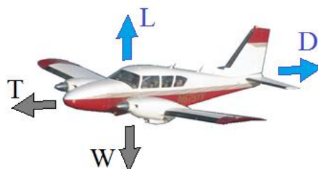
Figura 1- Reacciones aerodinámicas en un avión, L y D.
