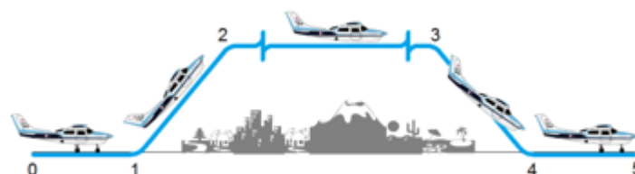
Figura 6- Perfil de Misión de crucero simple. Segmentos: 0-1 despegue; 1-2 Ascenso; 2-3 Crucero; 3-4 Descenso; 4-5 Aterrizaje.
