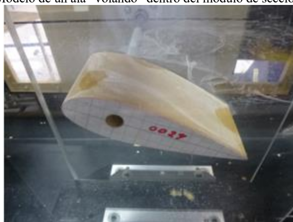
Figura 15- Modelo de un ala “volando” dentro del módulo de sección de pruebas.
