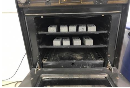
Figura 2. Probetas de roca en horno para secado
