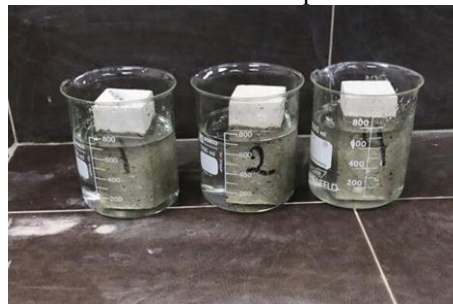
Figura 3. Probetas de roca en vaso para absorción de agua
